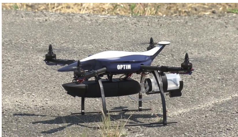
図 2-4 オプティムの農薬散布ドローン（オプティム社ホームページより）
