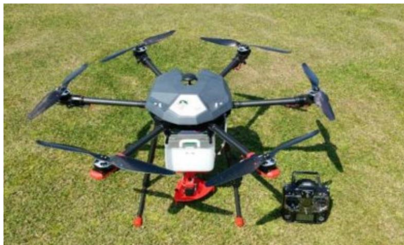
図 2-6 農業生産者が農業生産者の視点で独自開発した 農薬散布用ドローン「よしもと 5」 10)
